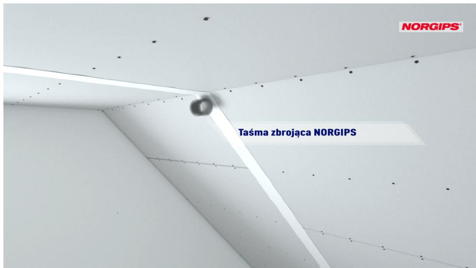
**21. Gipškartona plākšņu saplacinātu savienojumu špaktelēšana Q1 līmenī — konstrukcijas špakteles masas otrā slāņa uzklāšana un vietu pēc pašurbjošajām skrūvēm špaktelēšana**
